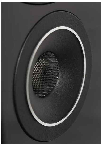
25-mm kopułka aluminiowa z warstwą ceramiczną chronioną jest przed uszkodzeniem siateczką, w centrum której umieszczono soczewkę akustyczną. Z kolei na zewnątrz przygotowano płytkie wyprofilowanie pełniące rolę falowodu.
